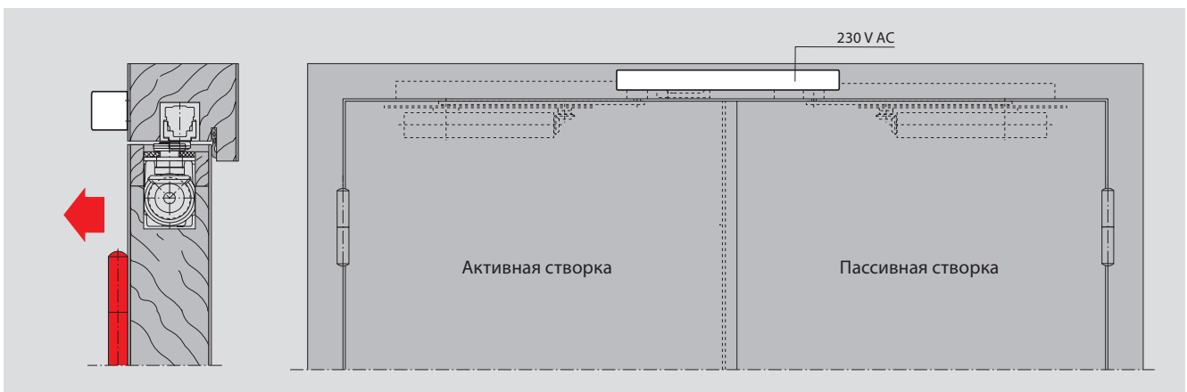
Центральный узел дымовой сигнализации RMZ со стороны петель вместе с ITS 96 GSR-EMF
