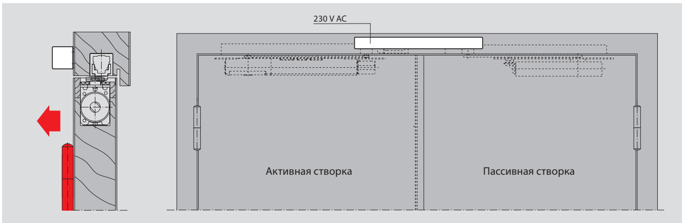
Центральный узел дымовой сигнализации RMZ со стороны петель вместе с ITS 96 FL GSR
